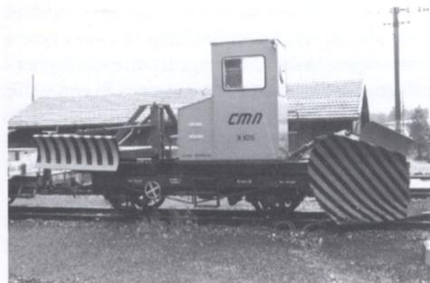
Um den Betrieb in den manchmal sehr schneereichen Wintern sicherzustellen, nahm die CMN 1988 den um 180° drehbaren Schneepflug X 105 in Betrieb (Les Ponts-de-Martel, 14.7.94; Foto M. Klausner)
